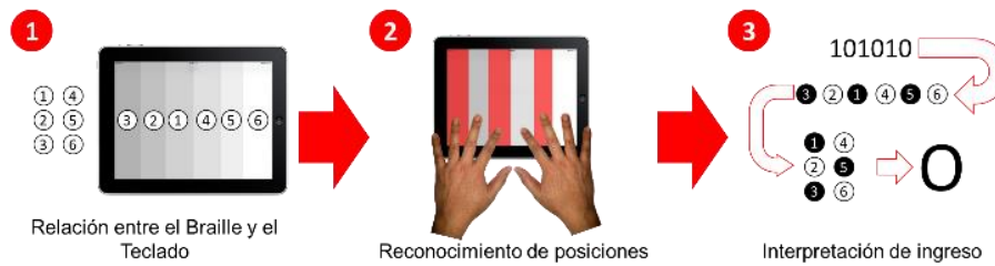
Figura 5 Proceso funcional para el teclado braille mediante reconocimiento de toques en la pantalla
