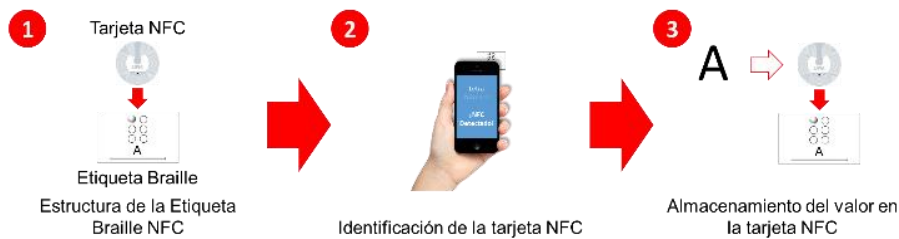
Figura 3 Proceso del registro de información de la tarjeta NFC al dispositivo móvil
